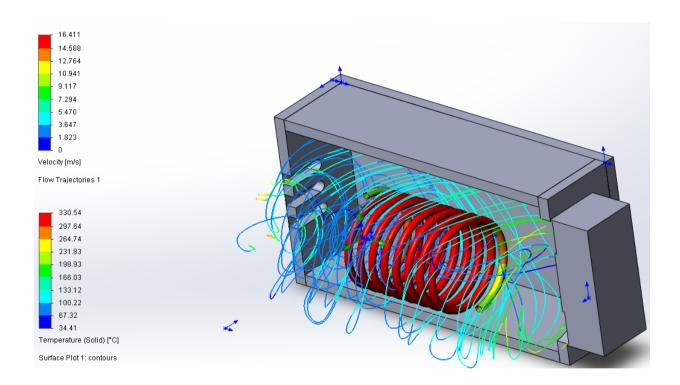
Из рисунка видно, что при заданных мощностях температура катушек составляет более 300°С, такой способ охлаждения очевидно не может быть использован, так как изменения геометрии трубки в результате теплового расширения приведут к изменению электрических параметров катушка индуктивности более чем на 1%.
